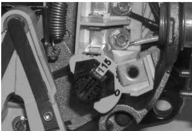
Figura 13: Motor configurado para una operación a 115 Voltios
